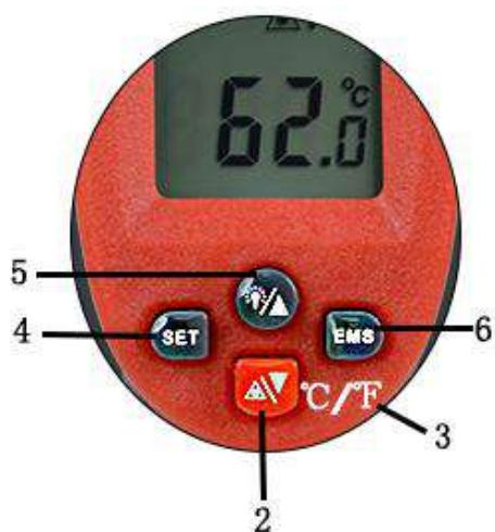
2- Positionnement laser : appuyez sur la gâchette, puis sur la touche 2 pour activer/désactiver la fonction de positionnement laser, dont l'icône s'affiche sur l'écran LCD.
