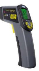
Certaines applications les plus courantes sont localiser des points chauds dans les boîtes électriques ou les roulements, le contrôle des pièces chauffées par induction de haute fréquence, contrôles de procédés et de stockage des aliments, vérifier la température dans les systèmes de chauffage et de climatisation, ou toute autre situation dont les différences de température peuvent compromettre le procédé.
